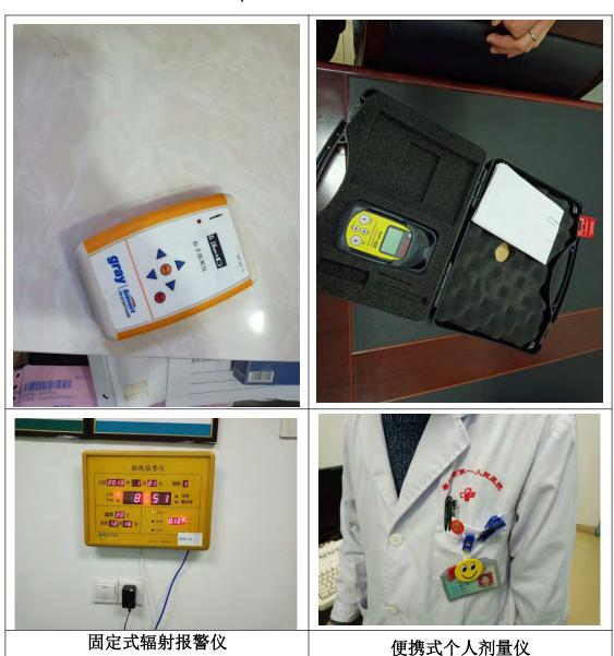
图3-4 直线加速器机房辐射监测设备
